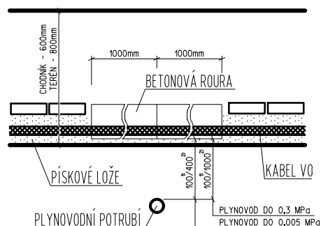
KŘÍŽENÍ KABELU VO A PLYNOVODU
